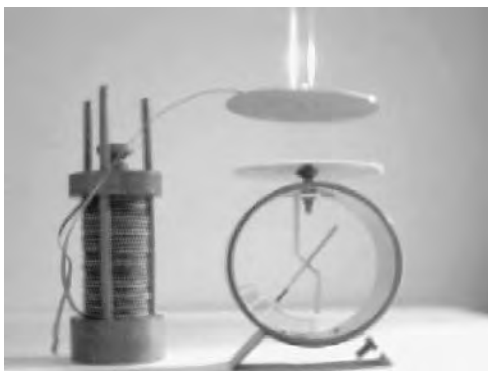
FIGURA 4. Detecció de l'electricitat feble de la pila amb el condensatore de Volta.
